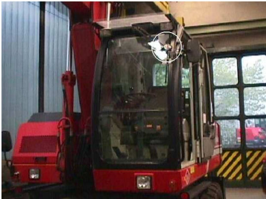
Abbildung 3.1a: Anbringung der Außenkamera mit Richtung auf den Arbeitsbereich
