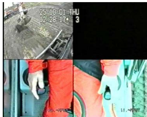
Abbildung 3.1d: Art der Darstellung auf dem Aufzeichnungsvideo, oben: Sichtfeld des Maschinenführers, unten: MFST-Bedienung
