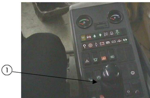
Abbildung 6: Rechtes MFST mit Bedienkonsole des Baggers 2 von Fa2
