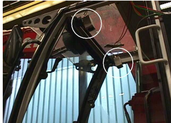
Abbildung 3.1b: Anbringung der Innenkameras, auf die beiden MFST ausgerichtet
