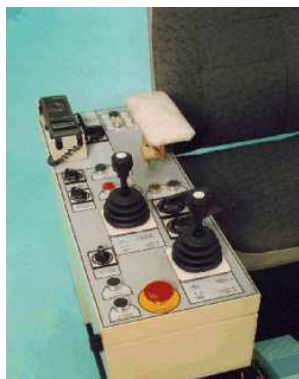
Abbildung 2.7: Bedienstuhl in einem Kran
